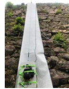
竹田城石垣の内部状況を地中レーダー(GPR)で探る。
